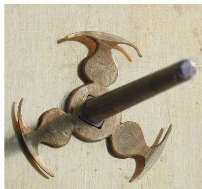
Détail de la bague de friction de qualité exceptionnelle sur le canon des minutes.
